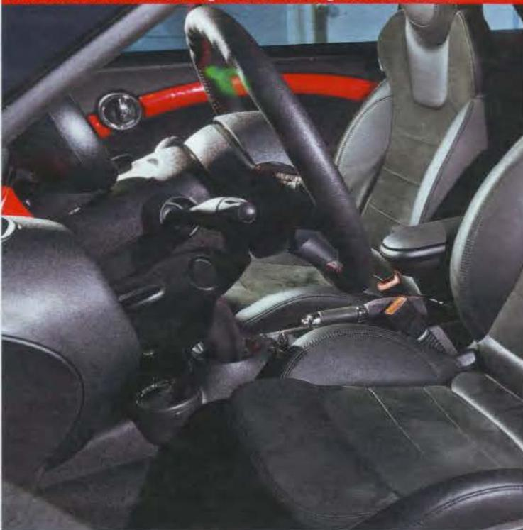
ment des Upgrades: das beim JCW-Coupé serienmäßige DTC. Die dynamische Traktionskontrolle erlaubt mehr Schlupf an den Antriebsrädern bei der Beschleunigung und sorgt in Kurven mit gezielten Bremsengriffen für mehr Stabilität. Am Ende kostet der SKN mit 38091 Euro 12791 Euro mehr als die Serie und liegt fast 7000 Euro über dem JCW - ein teures Vergnügen.
